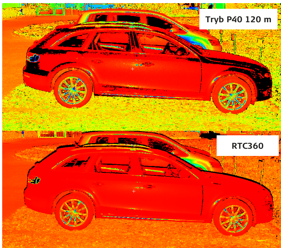
Rysunek 5: Porównanie tego samego skanu czarnego samochodu wykonanego za pomocą ScanStation P40 i RTC360.
