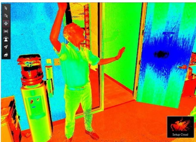
Rysunek 13a i 13b: Działanie filtra ruchomych obiektów w Cyclone REGISTER 360.
